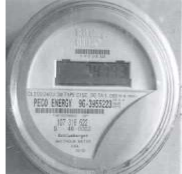
Complainant's Actual Meter Centron Smart Meter 240 v 3W 60Hz FM 2S Meter No. 107316622
